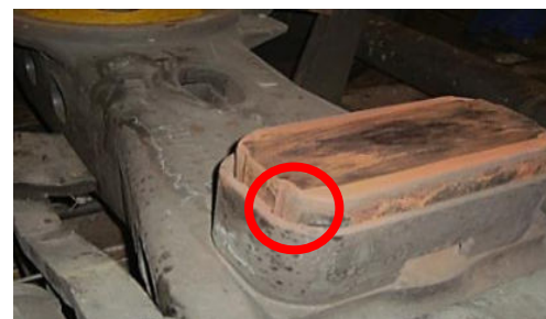
Индикаторы предельного износа скользуна
