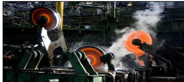
Цельнокатаные колеса из марки Т и с криволинейным профилем
