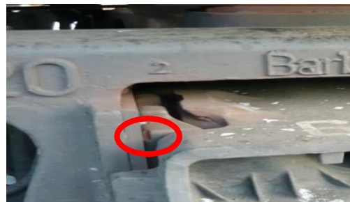
Индикатор предельного износа фрикционного клина
