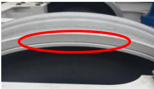
Индикатор предельного износа колеса
